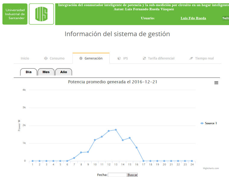
Figura 6.14: Potencia generada por el sistema fotovoltaico durante un día.
