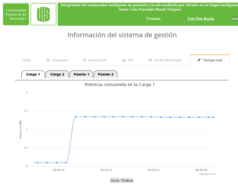
Figura 6.17: Visualización del consumo de potencia activa en intervalos de un segundo, ante la conexión de una plancha.
