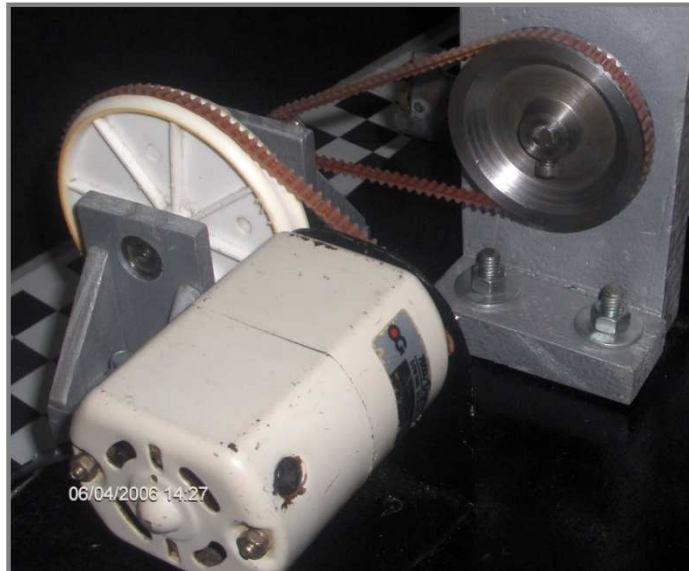
Figura 12. Motor universal y reducción por poleas
