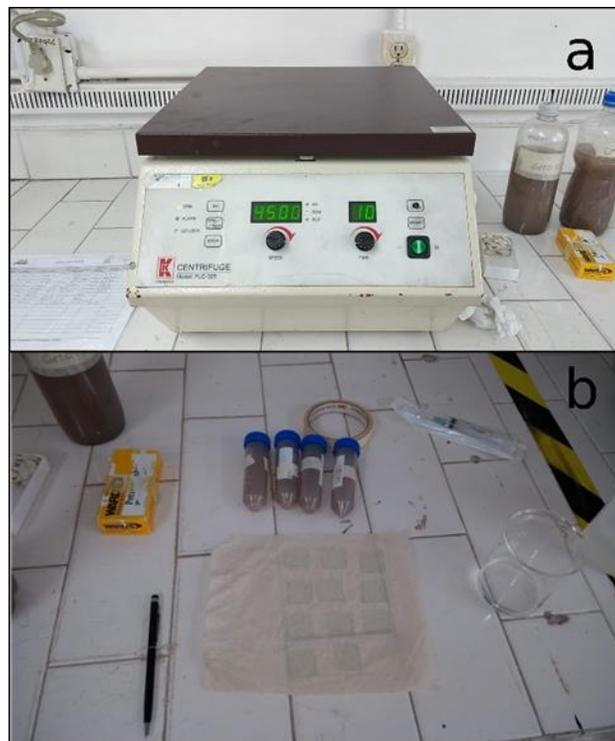
Figura 13. a) Centrifuga GEMMY PLC-025, b) materiales de trabajo para la separación de arcilla.
