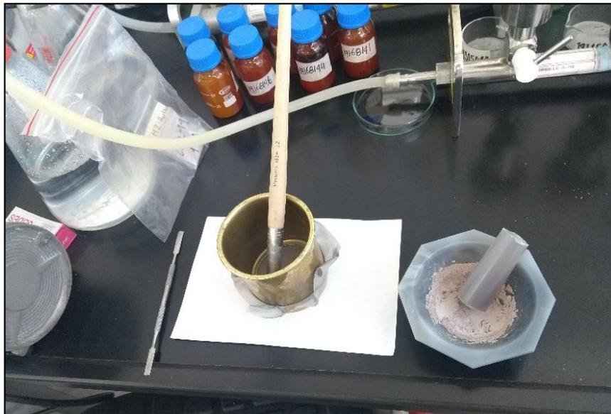
*Figura 11.* Mortero de ágata y malla No. 400 utilizada para la preparación de la porción de muestra para bulk.
