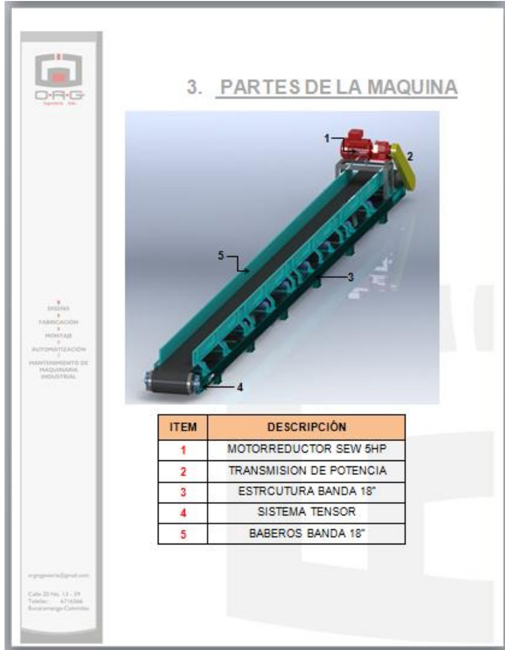
Figura 104. Partes de la maquina en el manual.
