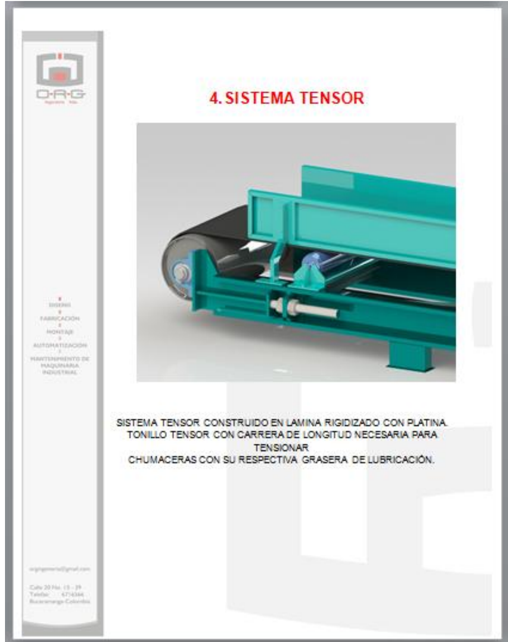
Figura 108. Sistema tensor del transportador de banda.
