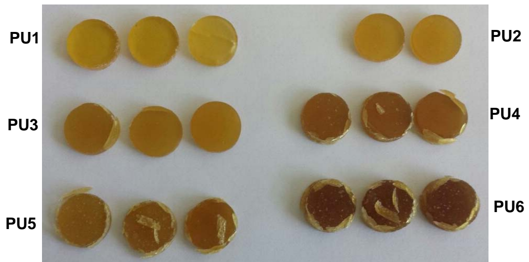
Figura 20. Muestras después del ataque químico - Gasolina
