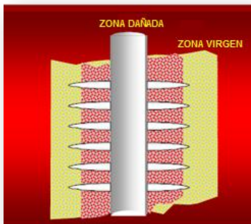
Figura 1 Cañoneo de pozos
