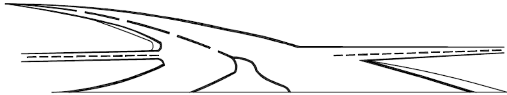
Figura 63. Localización recomendada de sitios de intersección
