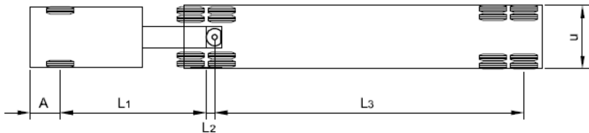
Figura 47. Dimensiones para el cálculo del sobreebancho requerido por el vehículo articulado representativo del parque automotor Colombiano.
