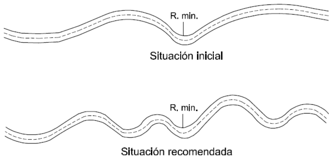
Figura 59. Transición de la geometría en sitios con radios cercanos o iguales al mínimo.
