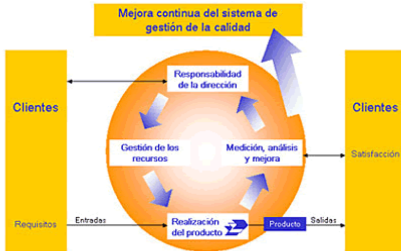
Figura 1. Modelo de un Sistema de Gestión de la Calidad basado en proceso
