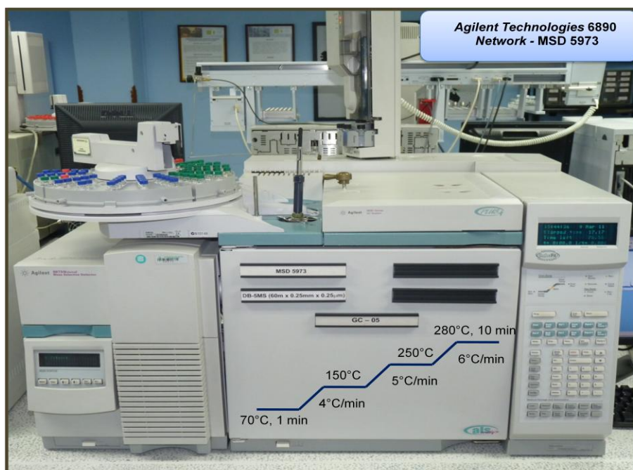
Figura 17. Fotografía del cromatógrafo de gases Agilent Technologies 6890 Plus , con detector selectivo de masas Agilent Technologies MSD 5973 Network . Columna DB-5 (60 m x 0,25 mm x 0,25 µm) con fase estacionaria de 5% fenil- poli(metilsiloxano). Fuente: Fotografía tomada por la autora; lugar: CENIVAM, UIS. Fecha: abril de 2010.
