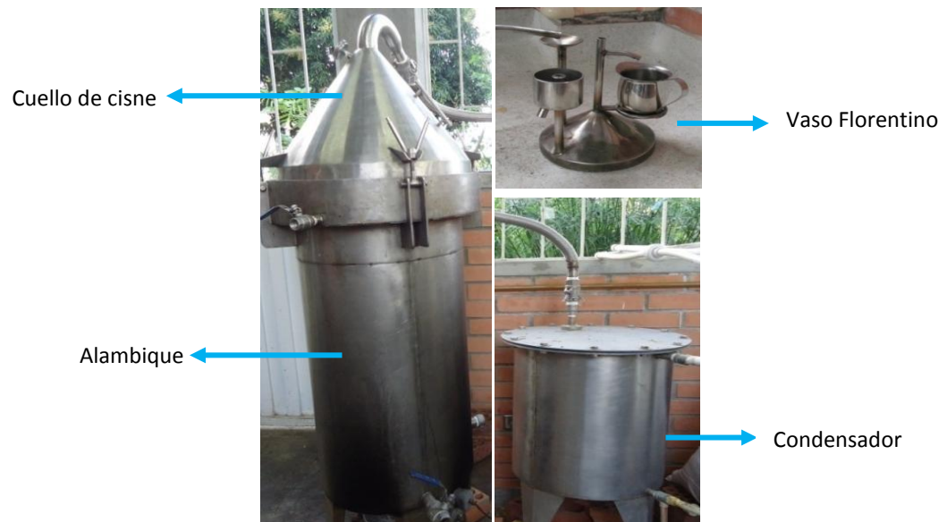
Figura 16. Fotografías del equipo a escala piloto empleado para la obtención de los AE por el método de destilación por arrastre con vapor. Fuente: Fotografías tomadas por la autora; lugar: CENIVAM, UIS. Fecha: abril de 2010.
