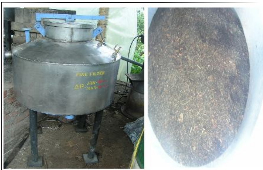
Fig 22. Foto del Filtro fino de aserrín
