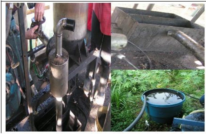
Fig 19. Hidrociclón y acumulador de agua.
