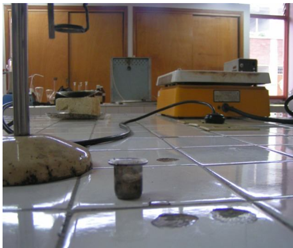
Fig 33. Crisol después realizar prueba de calor calorífico
