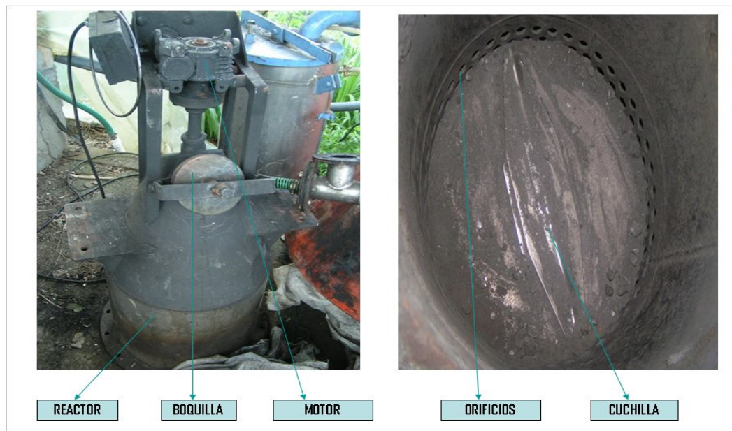
Fig 16. Foto del Reactor y sus componentes
