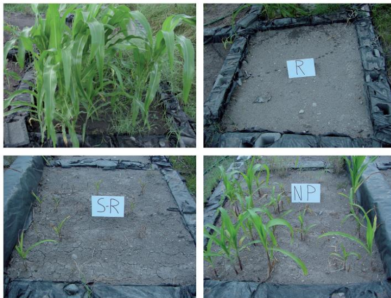
Figura 14. Resultados de los experimentos. La figura muestra los resultados del ensayo I del caso de estudio. se observa alta respuesta al crecimiento de las plantas en el caso de la configuración de suelos mezclados con cortes de perforación impregnados con hidrocarburos y con adición de nutrientes N y P.
