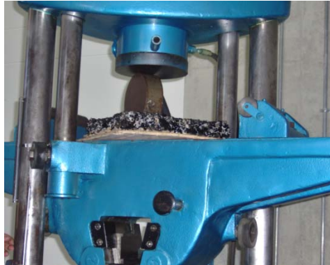
Fotografía 17. Prueba de resistencia de una muestra con la maquina universal
