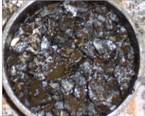
Fotografía 28. Riego de emulsión segunda capa probetas tipo Marshall
