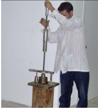
Fotografía 31. Compactación probetas tipo Marshall
