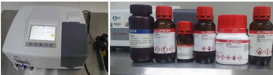
**Figura 6.** Espectrómetro Raman y patrones estándar
