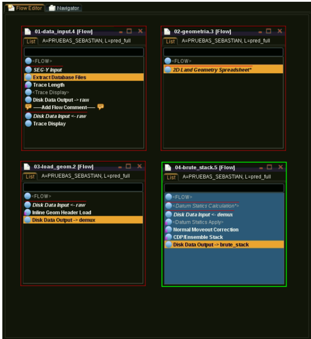
Figura 20. Flujos de trabajo empleados en PROMAX para generar la imagen apilada del conjunto de datos Alaska .
