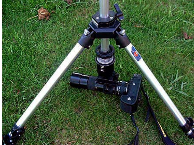
Figura 58. Trípode con columna central invertida para poder captar planos muy cercanos al nivel del suelo.
