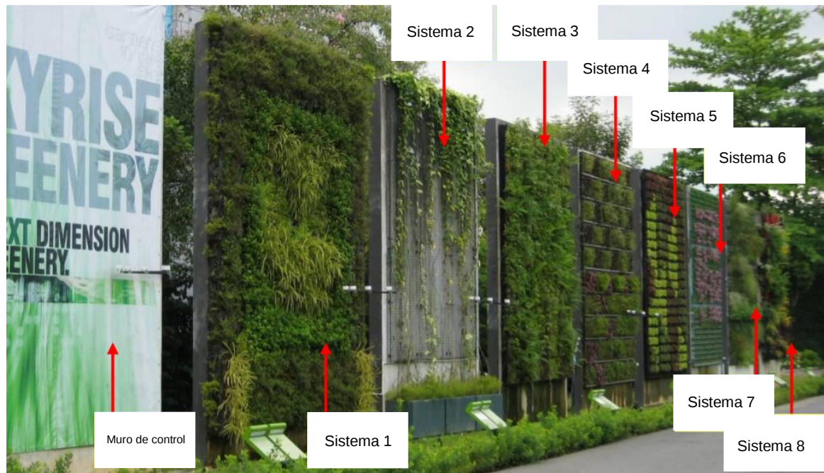
Figura 8. Pared de control y 8 diferentes sistemas de jardín vertical.
