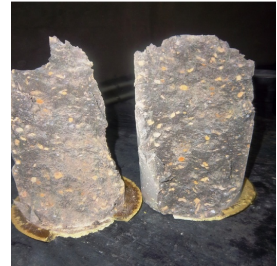
Probeta Mortero sometida a compresion
