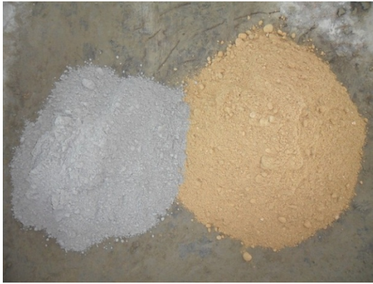
Porciones de cemento/relave para mezcla de mortero
