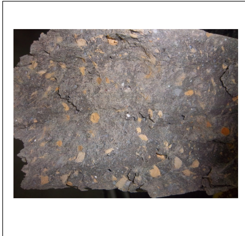
Figura 20. Superficie sólida de fragmento de mortero a base de relaves
