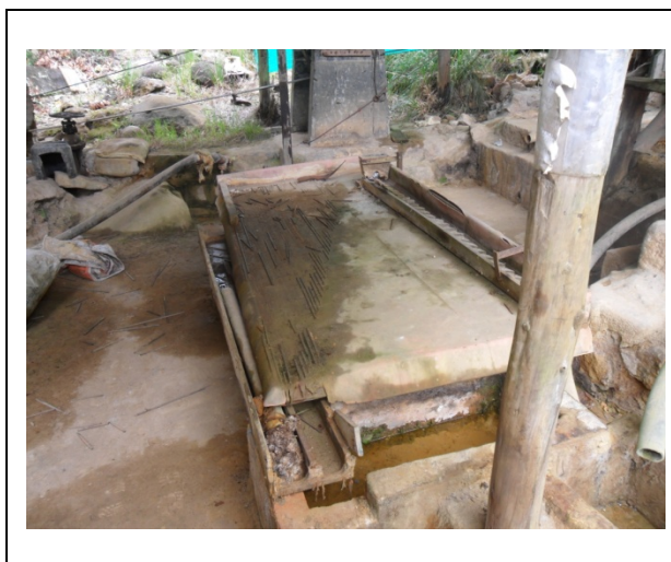
Figura 10. Mesa vibratoria Wilfley deteriorada
