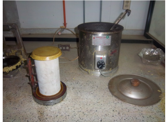
Probeta después de cabeceo de Azufre
