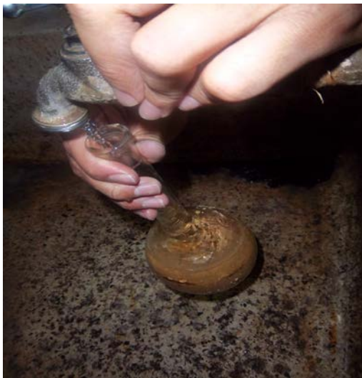
Muestra de Relave con agua (Determinación % de Absorción)
