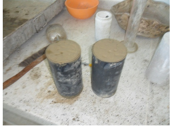
Mezcla final en estado plastico dispuesta en formalestas
