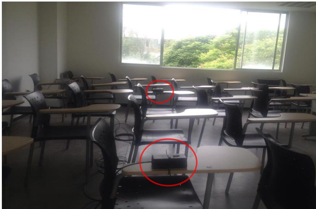
Figura 21. Instalación de los sensores BH1750FVI en el aula 302
