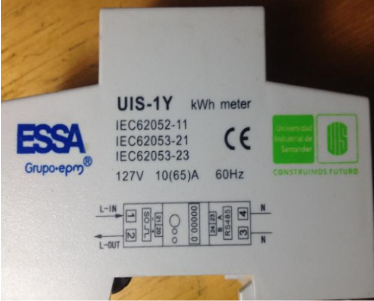
Figura 12. Medidor Monofásico YTL (UIS-ESSA).
