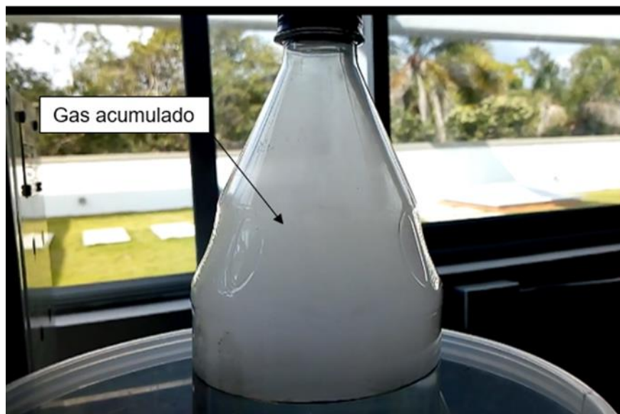
Fotografía 8 Gas producto del cisco torrefactado a 250°C a una temperatura de 365°C
