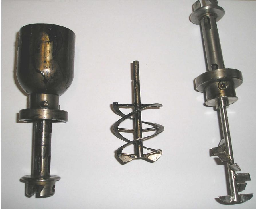
Figura I.1 - Recipiente cilíndrico y agitadores doble cinta helicoidal y cinta helicoidal
