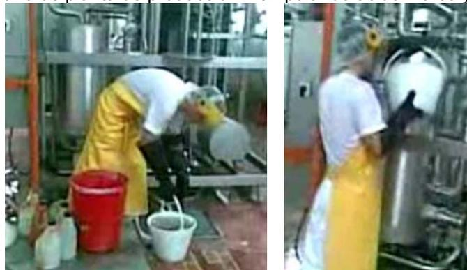
**Figura 5 :** Actual sistema dispensador de ácido nítrico y soda cáustica.
