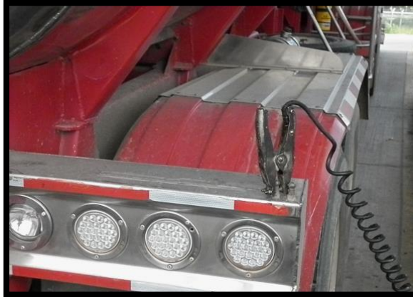
Foto 1. Polo a tierra Carro-Tanque.
