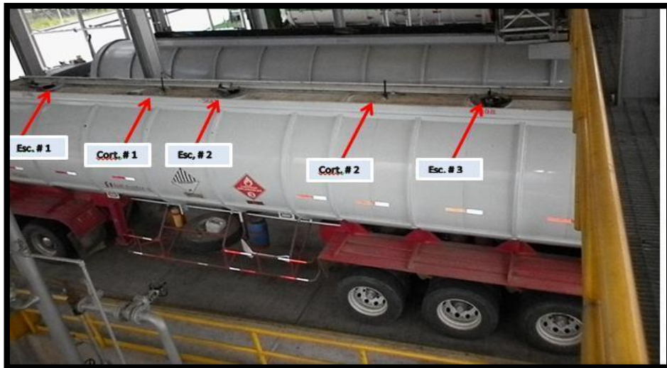
Foto 4. Ubicación de las Cortinas en los Carro-Tanques.
