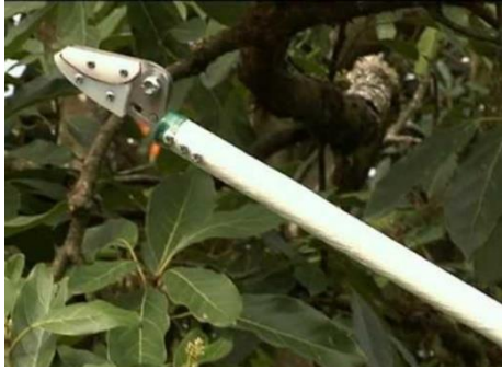
Figura 21. Tijeras cosechadoras fijas para aguacate Terravocado (Terravocado, s.f.) Llega a alturas de 1.7 m, 2 m y 2.6 m.
