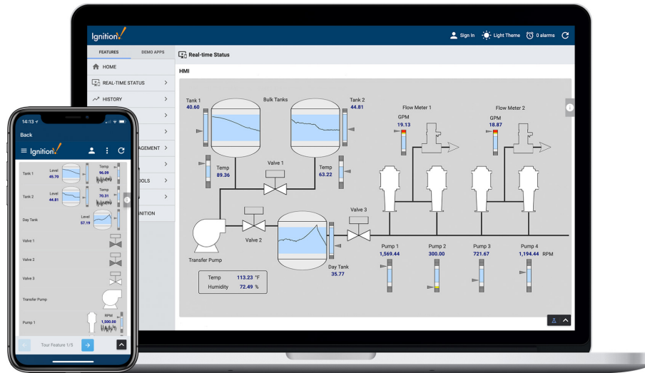
Figura 12 Interfaz Gráfica HMI en Ignition Designer
