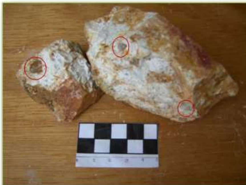
Figura 21. Aspecto de granito silicificado en matriz afanítica y fenocristales de cuarzo apreciados en los círculos rojos. Muestra TLG-E8-O2.
