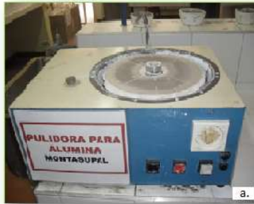
Figura 7. a) Pulidora de paño MONMTASUPAL y b) Abrasivos de Alúmina, para secciones doblemente Pulidas. Laboratorio de Preparación de Muestras, Escuela de Geología, Universidad Industrial de Santander.
