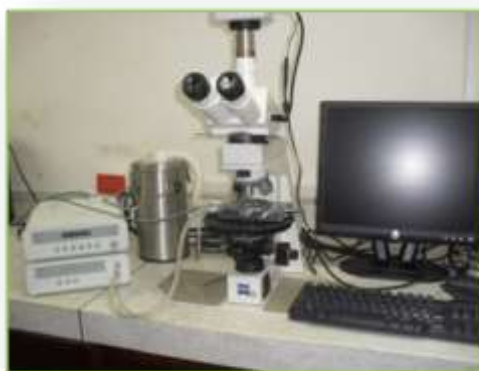
Figura 11. Equipo para microtermométrie de inclusiones fluidas. Microscopio de luz transmitida marca NIKON Elipse 50i, con platina de enfriamiento calentamiento THMS 600 marca LINKAM adaptada. Sede Guatiguará, Universidad Industrial de Santander.
