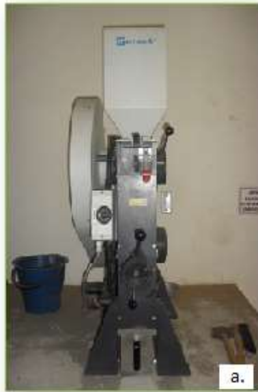
Figura 9. a)Equipos de trabajo utilizados en la pulverización de muestras. Trituradora de mandíbula RETSCH tipo BB200 SCHWERMETALLFREI y; b) mortero de Agatha RM 100 RETSCH. Laboratorio de Trituración de Muestras, Escuela de Geología, universidad Industrial de Santander.
