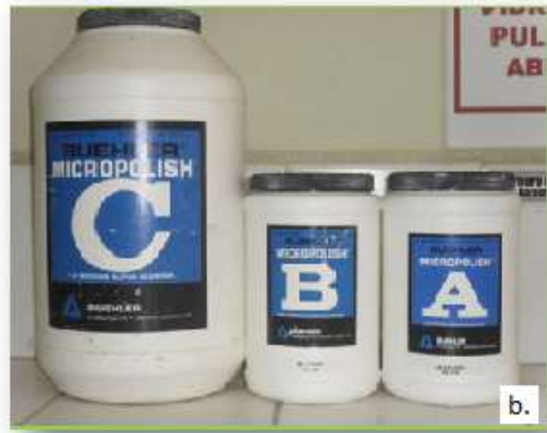
Figura 7. a) Pulidora de paño MONMTASUPAL y b) Abrasivos de Alúmina, para secciones doblemente Pulidas. Laboratorio de Preparación de Muestras, Escuela de Geología, Universidad Industrial de Santander.
