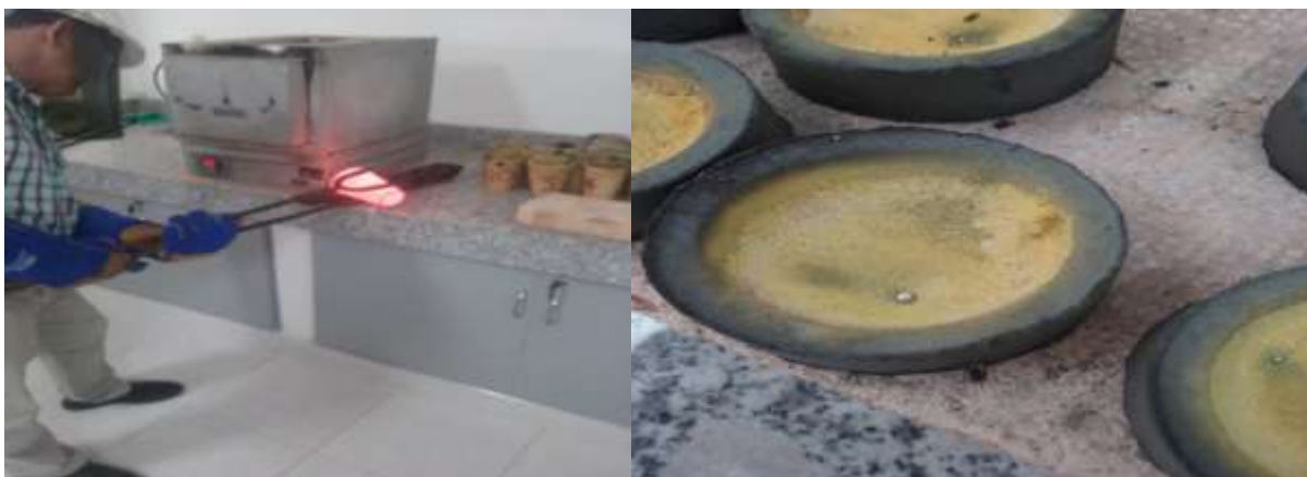
Figura 5. Colada de botón de plomo y copelas una vez reducido el plomo.
