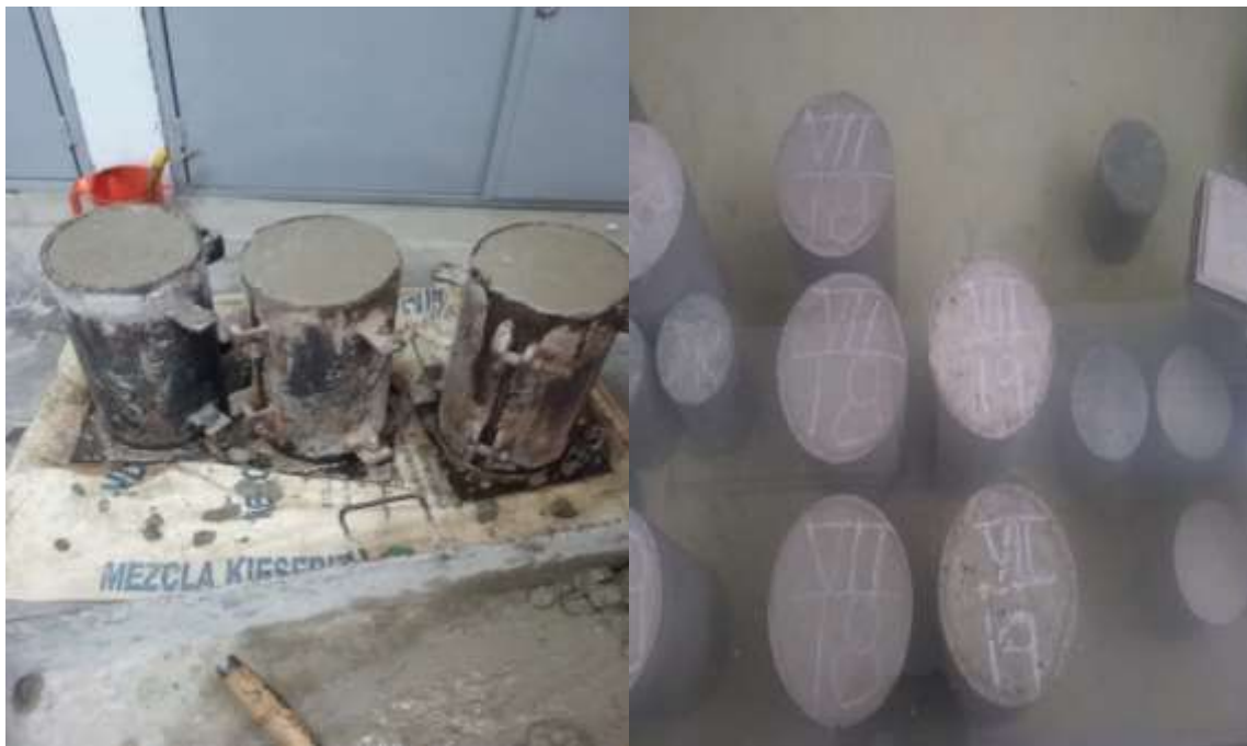
Figura 9. Fabricación y curado de probetas
