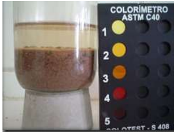
Figura F. Comparación de color mediante colorímetro ASTM
