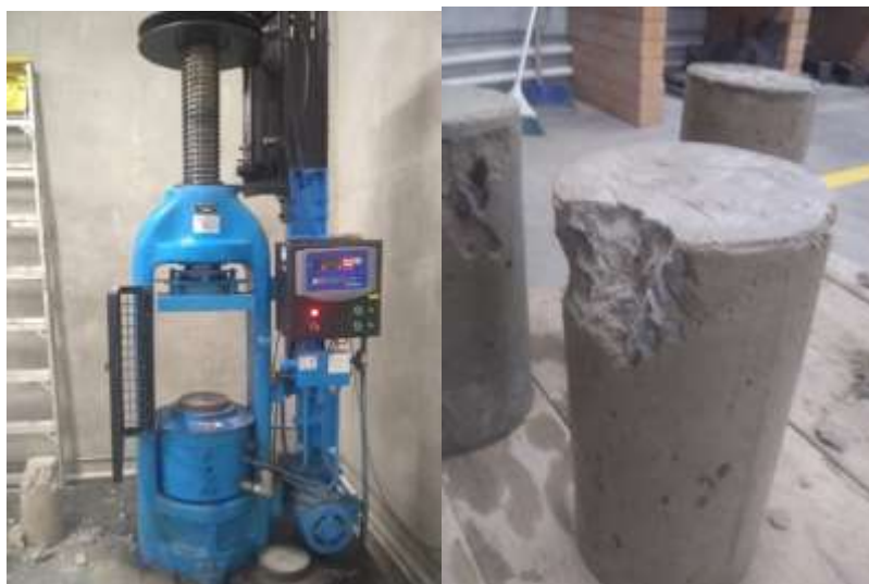
Figura 13. Ensayo a compresión de probetas de concreto
