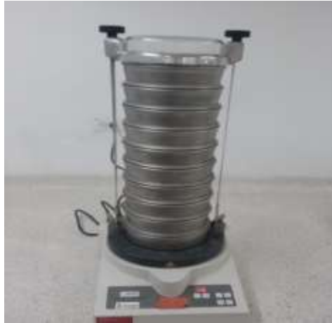
Figura 3. Análisis granulométrico con tamices ASTM
