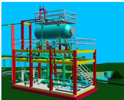
Ilustración 30. Skid de Hot-Oil.
