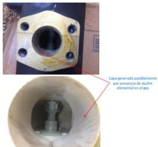
Ilustración 9. Capa generada posiblemente por presencia de Azufre Elemental.
