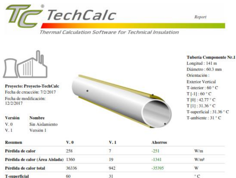
Ilustración 21. Reporte de pérdidas térmicas de tubería horizontal.
