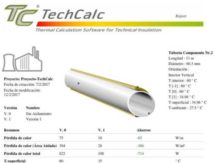
Ilustración 22. Reporte de pérdidas térmicas de tubería verticales.
