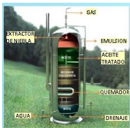
Figura 18 Tratador Térmico vertical
