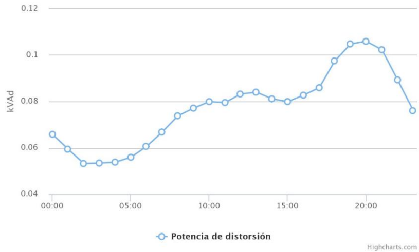
Figura 19 Curva de demanda diaria en potencia de distorsión armónica.
