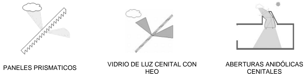
Figura 2. Ejemplos de sistemas guía de luz difusa
