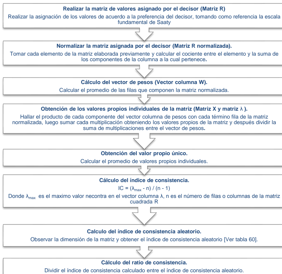
Figura 17. Etapas para el cálculo de consistencia de las prioridades de los criterios y atributos.
