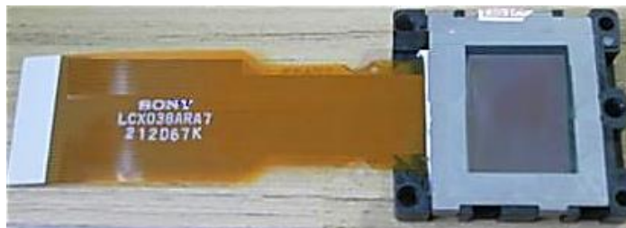
Figura 1. Matriz de cristal líquida SONY LCX038ARA [2].
