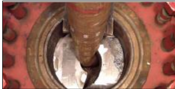
Figura 18. Tubería de perforación estrangulada por una válvula tipo ariete ciego
