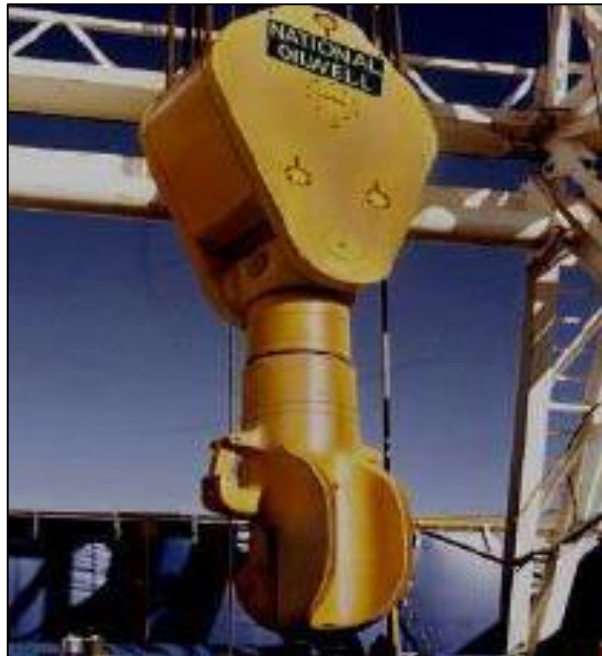
Figura 7. Bloque viajero típico de un RIG convencional
