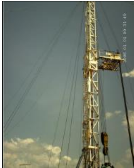
Figura 4. Encuelladero con tubería izada
