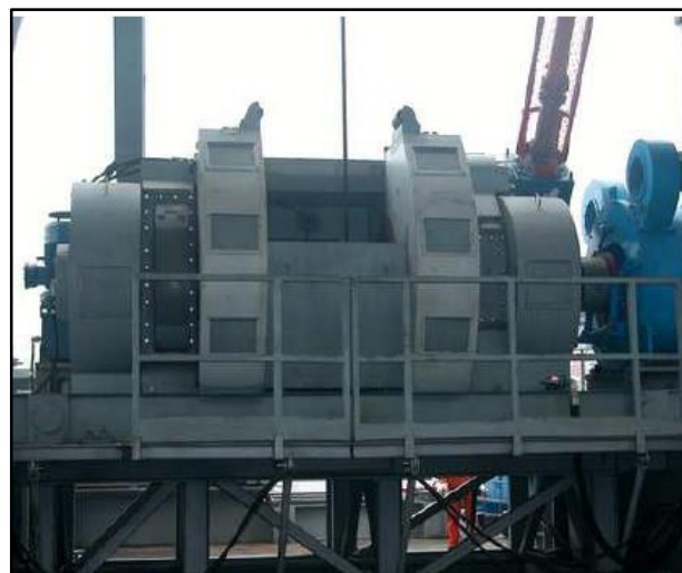
Figura 5. Malacate del sistema de levantamiento
