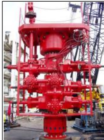
Figura 16. Conjunto válvulas impide reventones VIR
