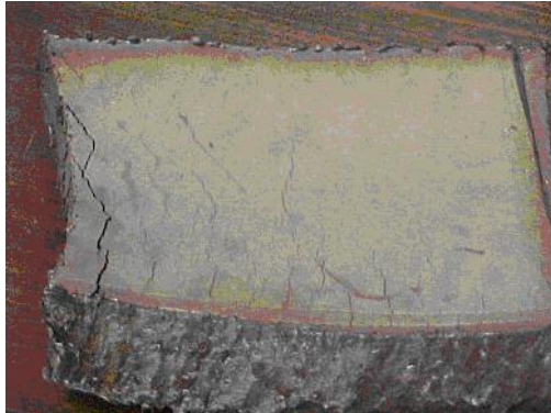
Figura 23. Grietas por fatiga térmica en el interior de un tubo de SS de pared gruesa
