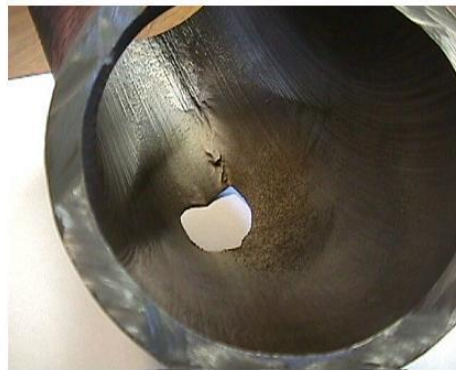
Figura 24. Erosión de un codo de retorno de un calentador de coquización
