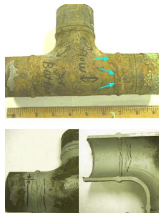
Figura 28. SCC en tubería de acero de retorno a un sistema de combustible etanol.
