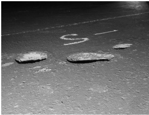
Figura 27. MIC en fondo de tanque de diésel.
