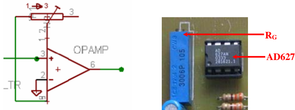
Figura 15. Esquemático y vista de la etapa de amplificación del equipo PWR-915
