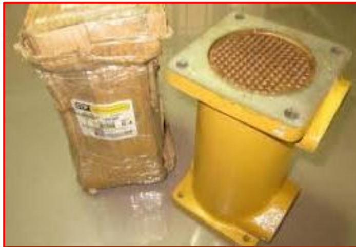
Figura 62. Enfriador de aceite.
