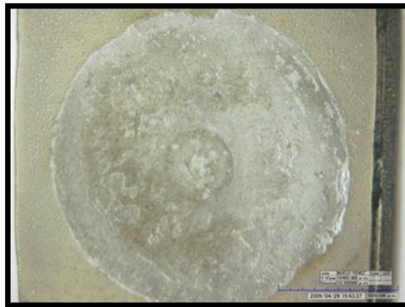
Figura 39. Superficies de las probetas de HA (a) y TiO 2 (b) a 20x, luego del ensayo de adherencia.
