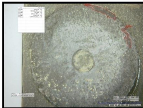
Figura 32. Superficie de la probeta P3 a 20x, luego del ensayo de adherencia.
