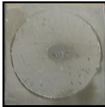
Figura 39. Superficies de las probetas de HA (a) y TiO 2 (b) a 20x, luego del ensayo de adherencia.
