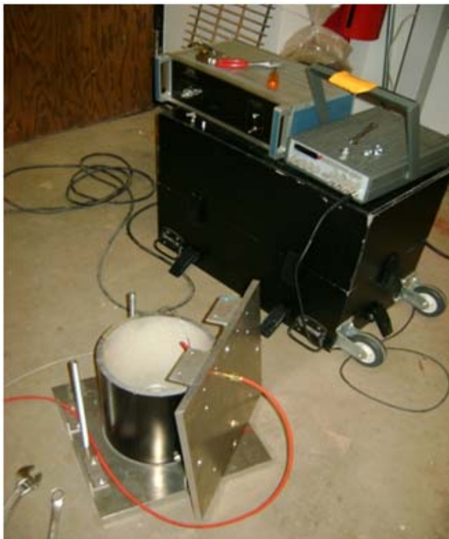
Figura 13. Control de frecuencia, control de amplitud y contenedor
