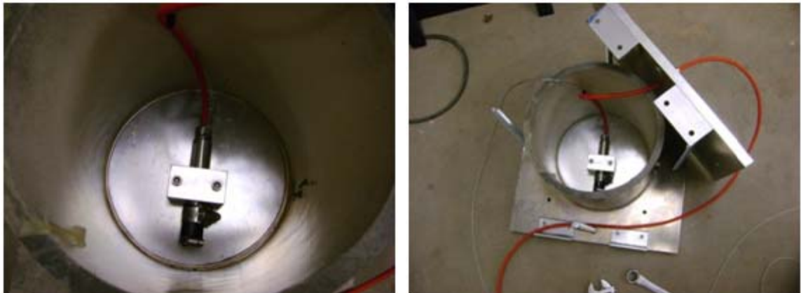
Figura 12. Transductor de presión de poros dentro del contenedor.
