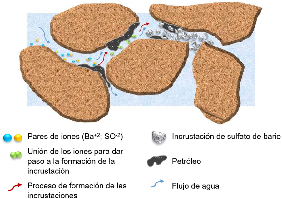
Figura 2. Daños en la matriz ocasionados por las incrustaciones minerales.
