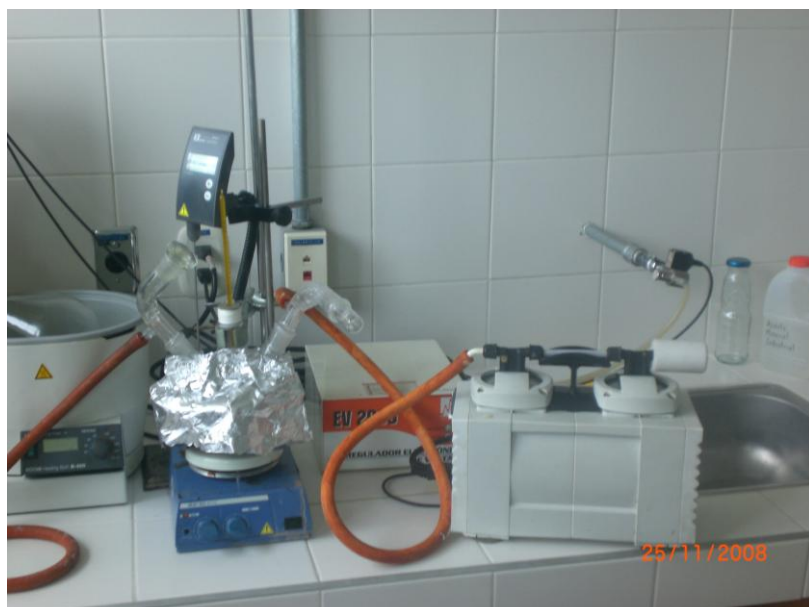
Figura A3. Montaje realizado para la síntesis de PGA.
