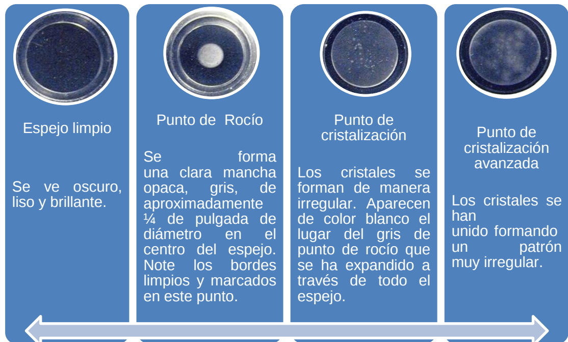
Figura 16. Formación típica del Punto de rocío
