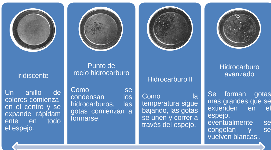
Figura 19. Punto de rocío de hidrocarburo usando gasolina.
