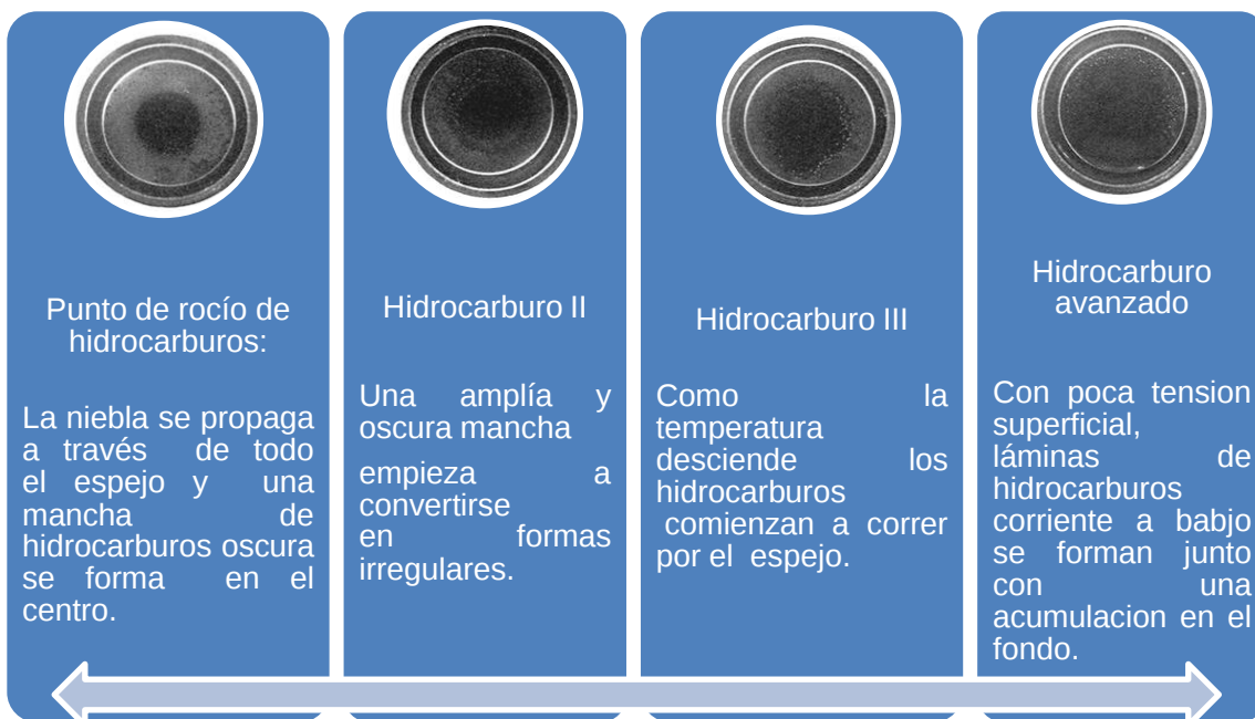
Figura 18. Punto de rocío de hidrocarburo usando propano.
