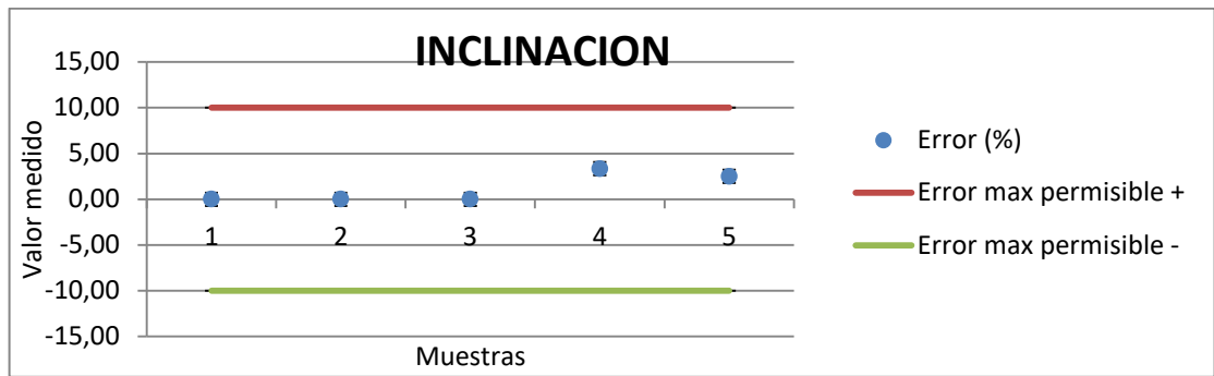
Figura 12. Verificación de rangos de inclinación. Fuente: CDA MotoCesar
