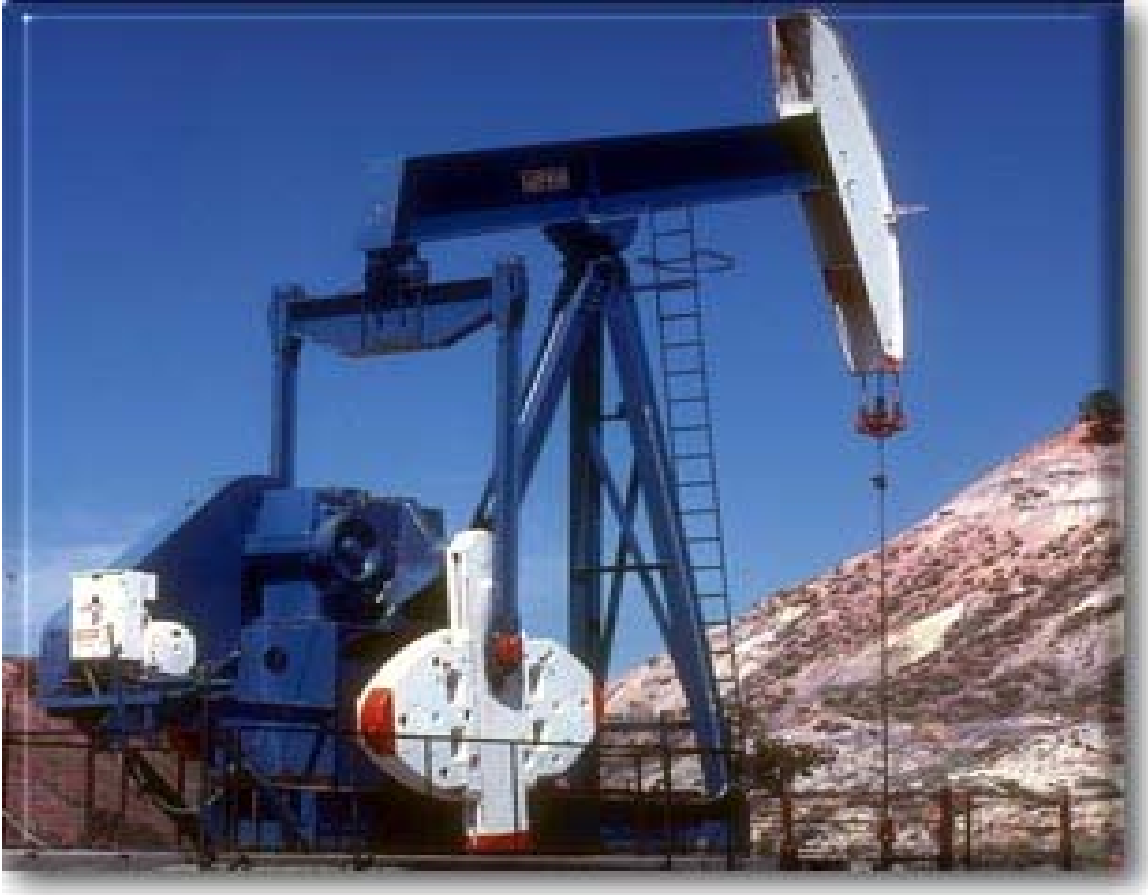
Fig. 1 Sistema de bombeo mecánico
