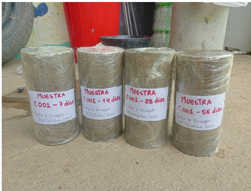
Figura 6. Toma de muestras de concreto
