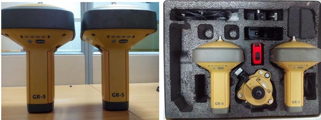
Figura 18: Detalle equipo RTK
