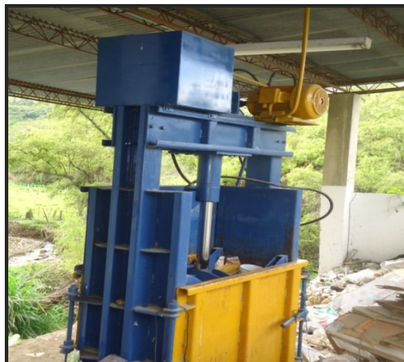
Imagen 5. Estado actual de la compactadora
