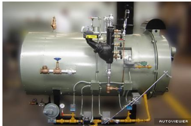
FIGURA 1: Caldera Pirotubular Marca Continental
