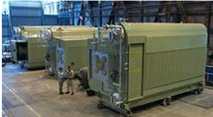
FIGURA 2: Caldera Acuotubular Marca Babcock & Wilcox
