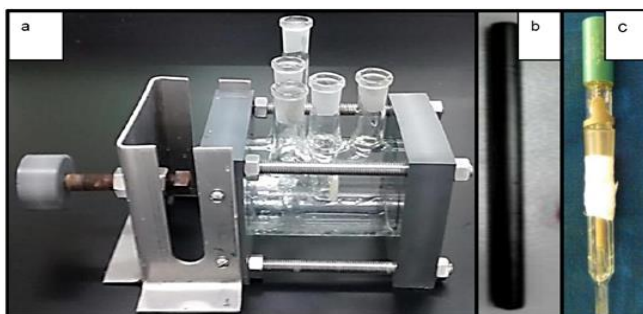
Figura 6. Montaje de la celda electroquímica. a) Celda electroquímica plana. b) Electrodo de Ag/AgCl. c) Contra electrodo de grafito.
