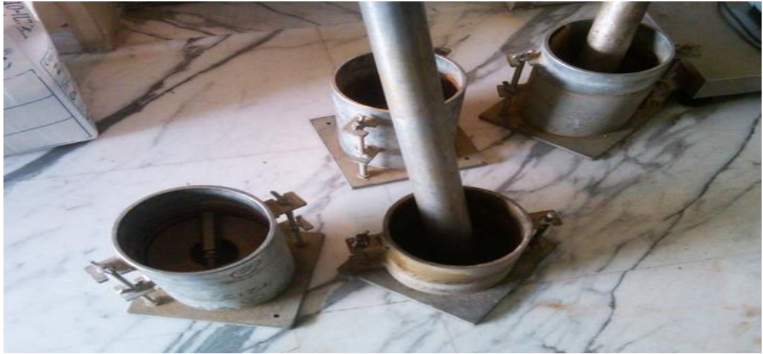
Figura 17. Ensayo de Proctor 27
