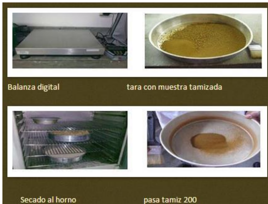
Figura 11. Ensayo granulometría-secado muestra 16
