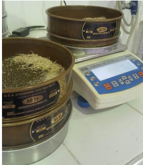
Fig. 1 Pesaje de las fracciones retenidas en los tamices seleccionados.
