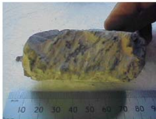
Figura. 15. Caving en bloque de planos de debilidad: estratificación o fracturas Naturales.
