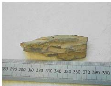
Figura 13. Caving angular asociados a fallas por cizallamiento.
